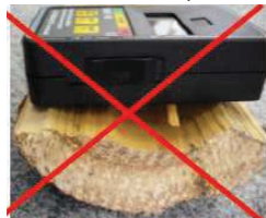
Špatně: nerovný povrch (extrémní příklad)
