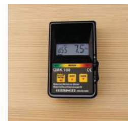
Obr. 2: Položený přístroj - OK!
