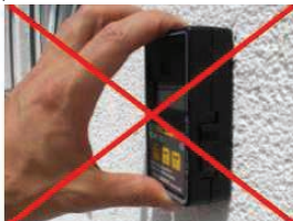
Špatně: nepravidelný povrch
