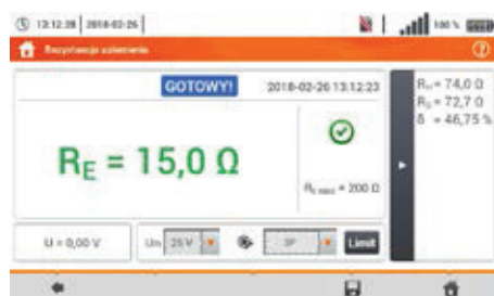
Měření odporu uzemnění
